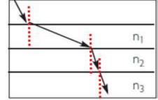
**IV.** Completa el trazado de rayos, de manera que, respetando la ley de refracción, se evidencie que  $n_3 > n_2 > n_1$  (considera que el rayo antes de entrar al primer medio, viaja a través del vacío).(1 pto)
